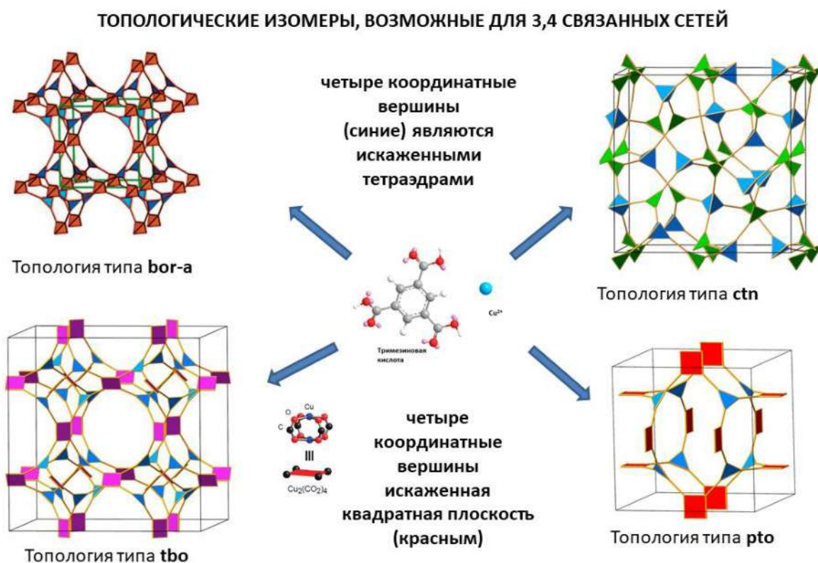
Рисунок 3.1 – Трехмерные топологические изомеры, возможные для исследуемой системы тримезината меди исходя из ретикулярного синтеза
