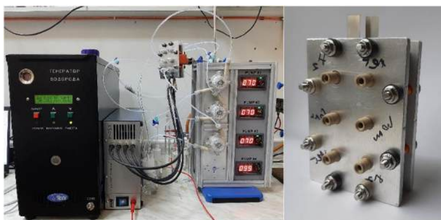
Рисунок 17 – Фотографии ячейки КОМ+АОМ НПБ (справа) и экспериментальной установки для ее исследования (слева)
