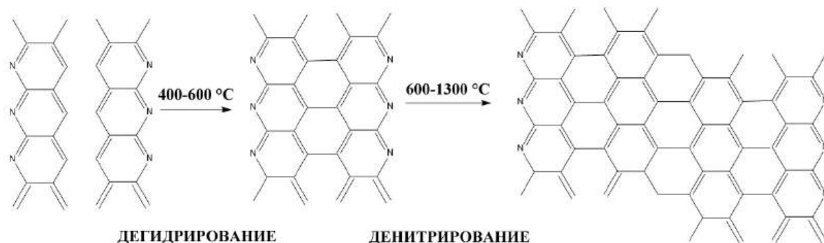
Рисунок 1.9 - Схема образования графита в процессе карбонизации
