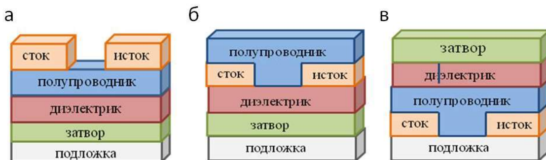
Рисунок 3 – Типичные конфигурации ОПТ: затвор снизу, сток-исток сверху (BG - TC) (а), затвор снизу, сток-исток снизу (BG - BC) (б), затвор сверху, сток-исток снизу (TG - BC) (в)
