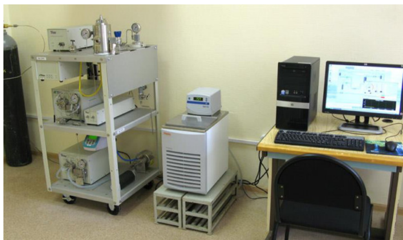
Рисунок 2.6 –Система для проведения реакций в суб- и сверхкритических флюидах R250–2–BASE
