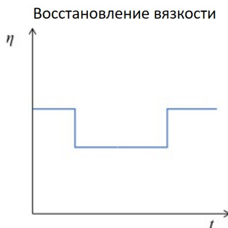
Рисунок 10 - Печатные материалы должны восстанавливать свое вязкоупругое поведение при деформации, вызванной напряжением сдвига, чтобы производить 3D-конструкции с надлежащей точностью формы [90]
