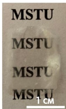
Рисунок 46 – Фото пленки, полученной из геля с c_{\text{tot}} = 13 масс. % и R_{\text{ПНИПАМ/НКЦ}}^m = 1,0 , толщина пленки составляет 220 микрометров
