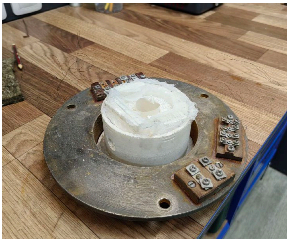
Рис. 1 – Фотография экспериментальной сборки для проведения ударного нагружения и регистрации профилей скорости свободной поверхности при отрицательных температурах.
