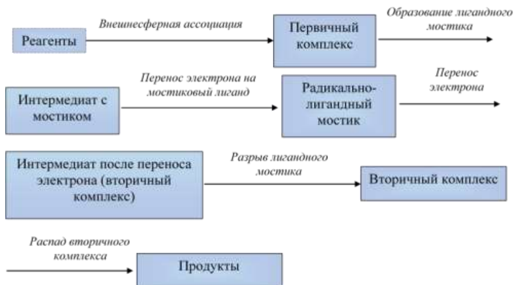
Рисунок 9 - Элементарные стадии общего внутрисферного механизма переноса электронов [125].
