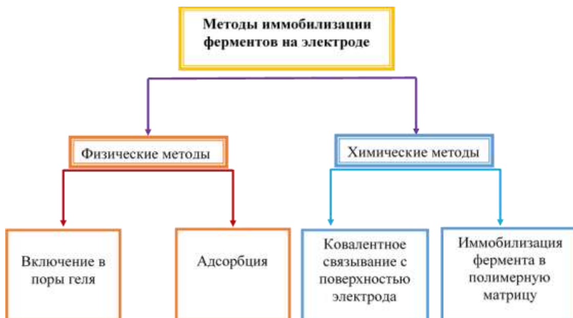
Рисунок 5 - Классификация методов иммобилизации ферментов на электроде.
