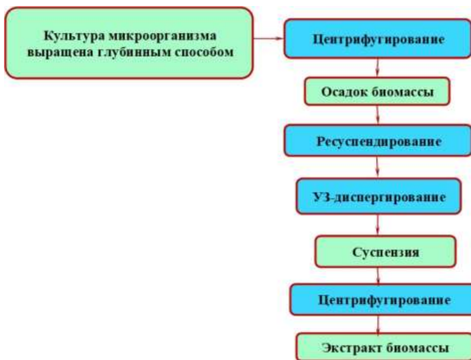
Рисунок 23 - Принципиальная схема получения грубых экстрактов из культур микроорганизмов.
