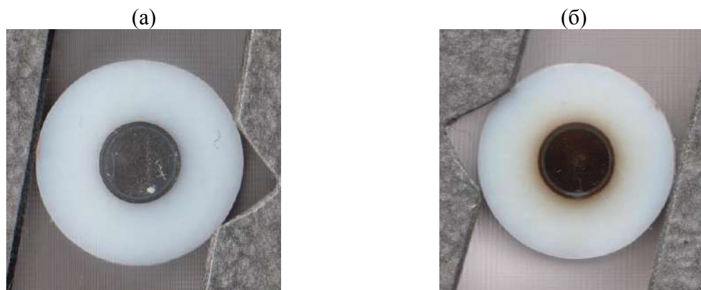
Рис. 3.35. Поверхность ВДЭЖ после опыта по электрополимеризации MgP в отсутствие (а) и в присутствии (б) добавки лутидина.
