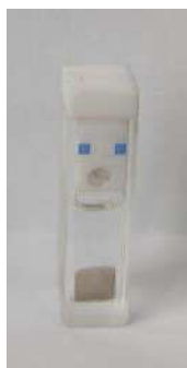
Рис. 2.8. Фото кварцевой кюветы с крепежным механизмом в крышке для измерения спектров поглощения образцов покрытий на ИТО-электроде.
