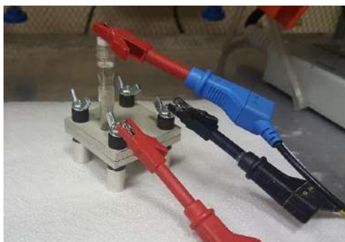
Рис. 5.5. Фото установки для испытаний модифицированных рСоР-II углеродных электродов в симметричном суперконденсаторе.
