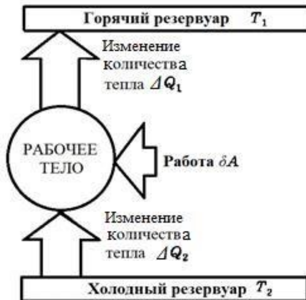
Рисунок 1.1. Схема работы холодильной машины по обратному циклу Карно [35].
