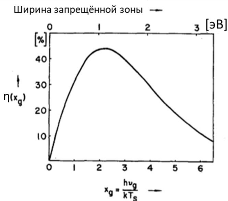
Рисунок 17. Зависимость КПД фотоэлемента от ширины запрещённой зоны [71].
