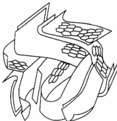
Рисунок 1.1. Усредненная структура активированного угля [3].
