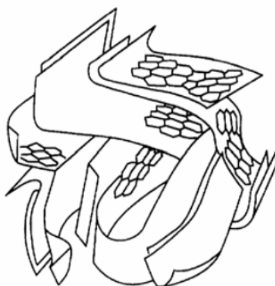
Рисунок 1.1. Усредненная структура активированного угля [3].
