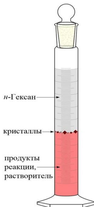
**Рисунок 36.** Иллюстрация метода жидкостной диффузии, применявшегося в данной работе для получения монокристаллов.
