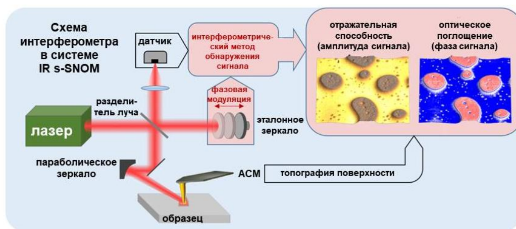
Рисунок 3.7 — Схема получения карты отражательной способности образца и карты распределения поглощения ИК-сигнала на выбранной частоте в методе IR s-SNOM
