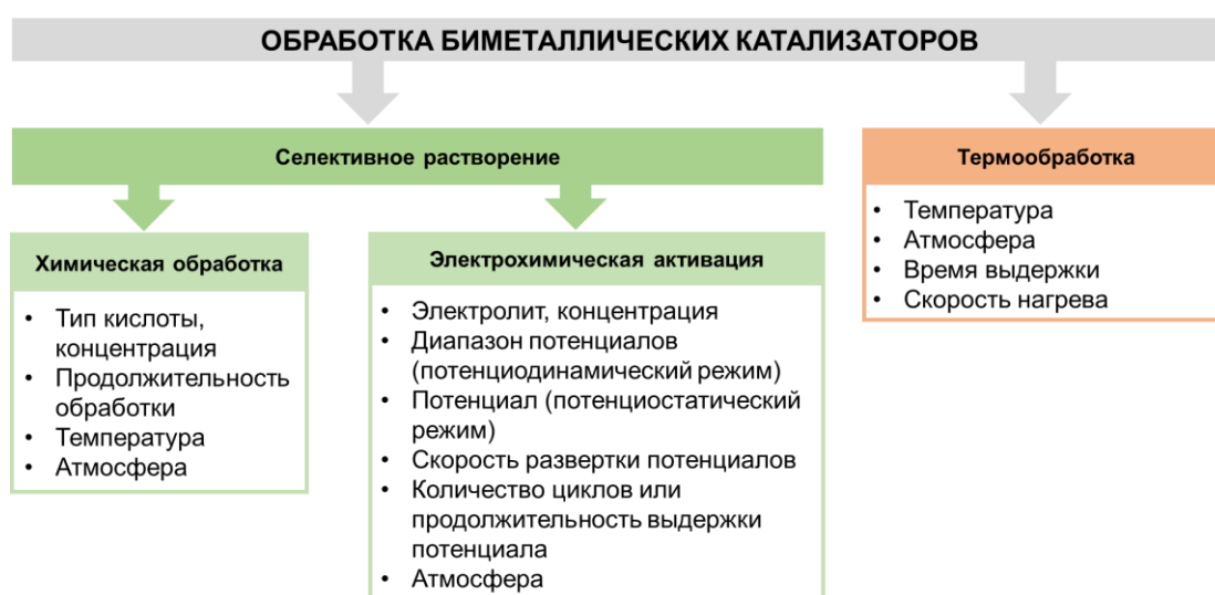
Рисунок 1.8 – Схематическое изображение типов обработки биметаллических катализаторов. Указаны параметры, которые можно изменять в процессе обработки
