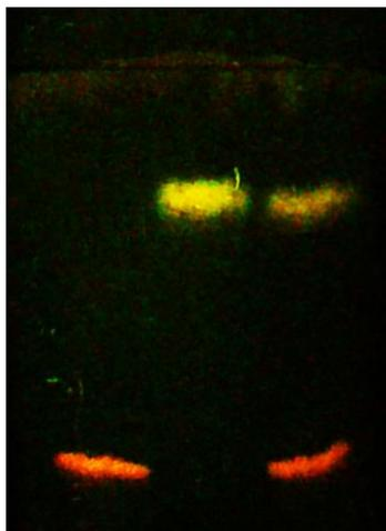
Рисунок 59 – Хроматограмма смеси 1: 1 родамина Б и родамина 101 (Б) на композитном сорбенте Са-7: слева – хроматограмма родамина 101, центр – родамина Б, справа – смеси родаминов. Элюент – смесь тетрахлорэтилен: метанол 7.33: 1. Возбуждение светом 365 нм
