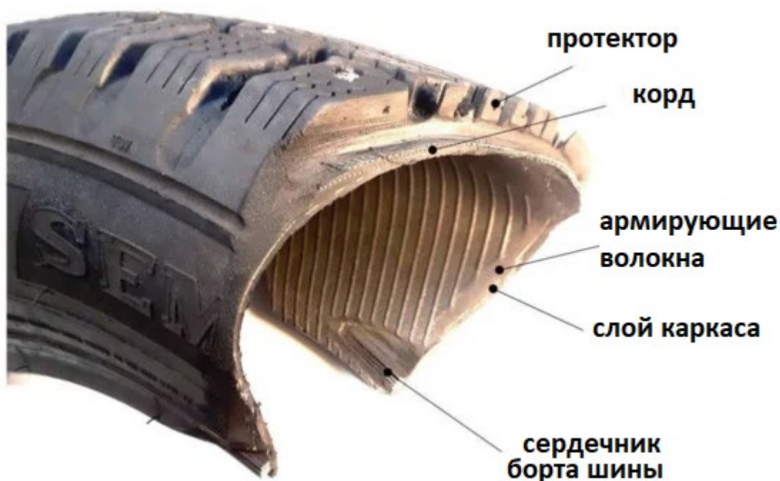
Рис. 1.7. Типичная автопокрышка и ее компоненты [39].
