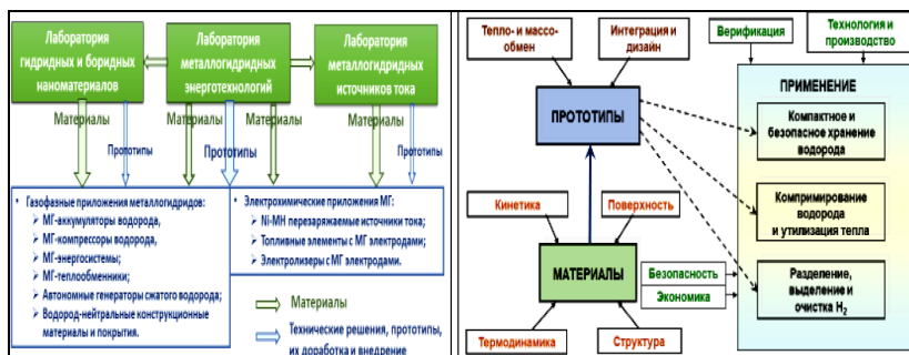
Рис. Комплекс лабораторий водородного материаловедения: состав и стратегия перехода от материалов к устройствам
