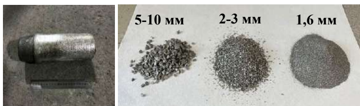
Рис. 1. Процесс изготовления металлгидридного сплава АВ5: выплавка слитка (а), стадии измельчения в порошок (б)
