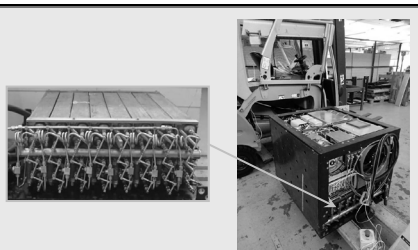
Рис. 4. Аккумулятор водорода для погрузчика на топливных элементах (2 кг H 2 ) центра компетенции HySA Systems (ЮАР)
