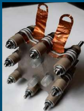
Схема и фотография ячейки нейтрализационной батареи
