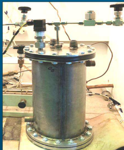
Разработанный накопитель-компрессор водорода низкого давления (слева) и в интеграции с электролизером и компрессором водорода (справа)
