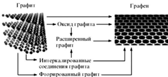
Рис. 3. Схема получения графена из графита [84]
