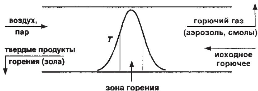
Рис. 2. Схема фильтрационного горения в сверхадиабатическом режиме
