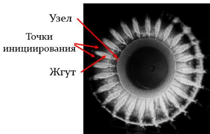
Рисунок 1 – Неоднородность сходящейся детонационной волны при цилиндрическом обжатии
