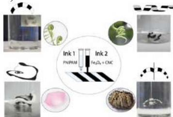
Рисунок 1. Схема получения мультистимульного актюатора и примеры форм, которые были получены.
