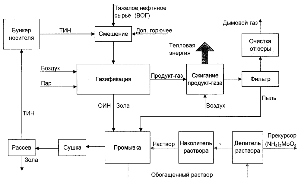
Фиг.1. Принципиальная схема регенерации молибденового катализатора гидроконверсии тяжелого нефтяного сырья.
