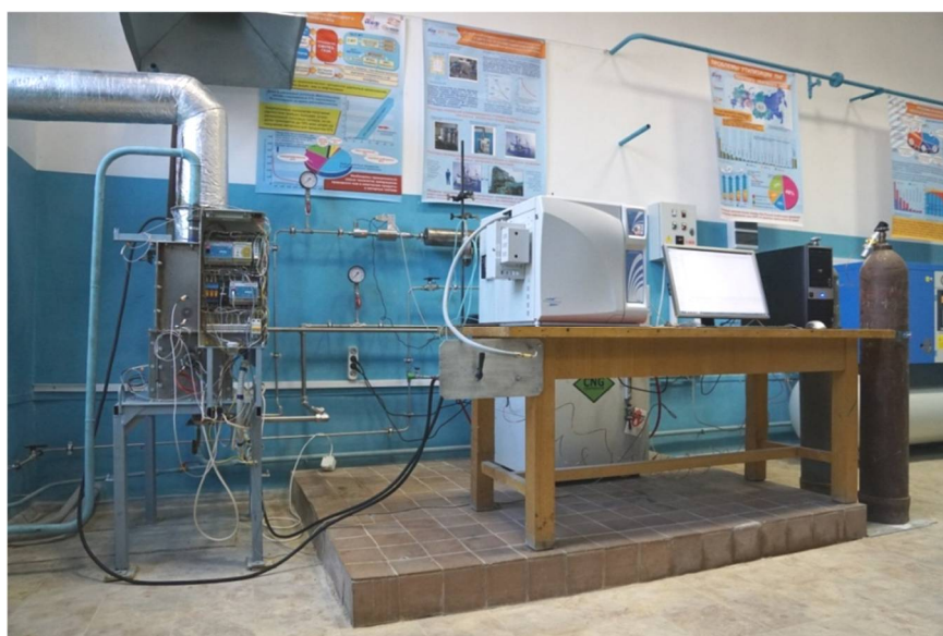
Рисунок 1. Внешний вид установки матричной конверсии метана в синтез-газ для работы при атмосферном давлении, производительность по метану до 20 \text{ м}^3/\text{ч}
