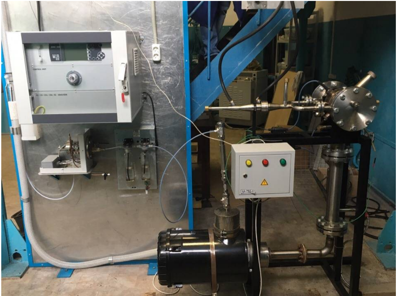
Рисунок 3. Внешний вид установки матричной конверсии метана в синтез-газ для работы при атмосферном давлении, производительность по метану до 2 м 3 /ч
