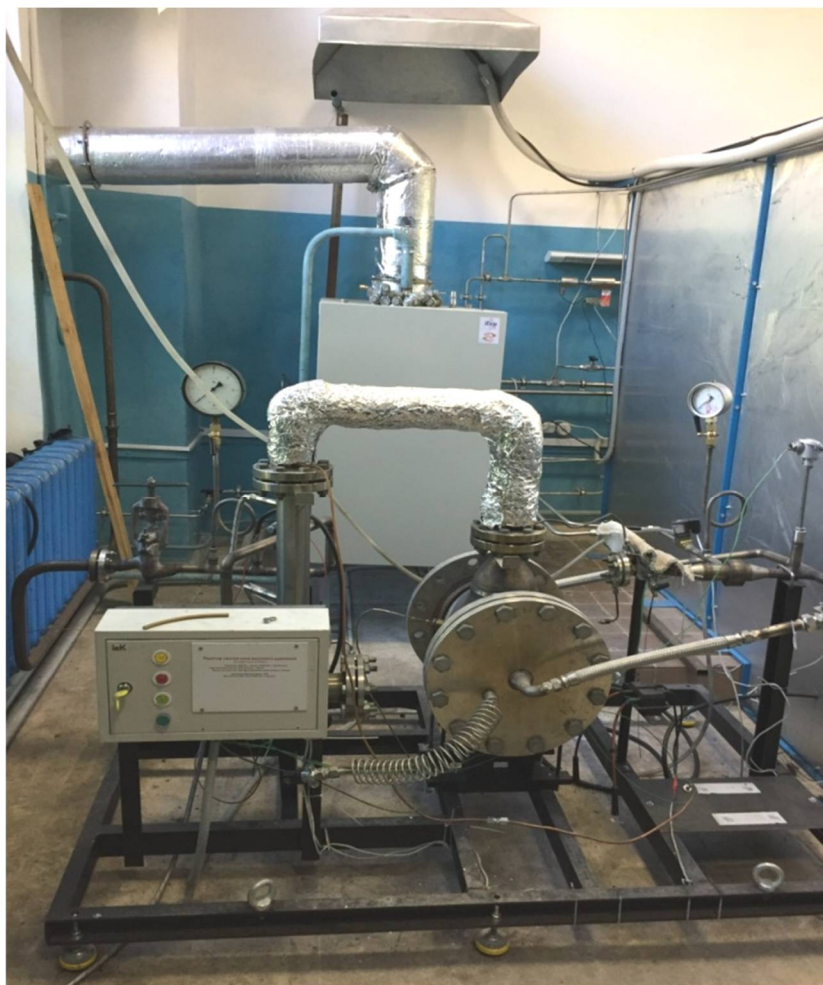
Рисунок 2. Внешний вид установки матричной конверсии метана в синтез-газ для работы при повышенных давлениях, производительностью до 10 \text{ м}^3/\text{ч} по метану.
