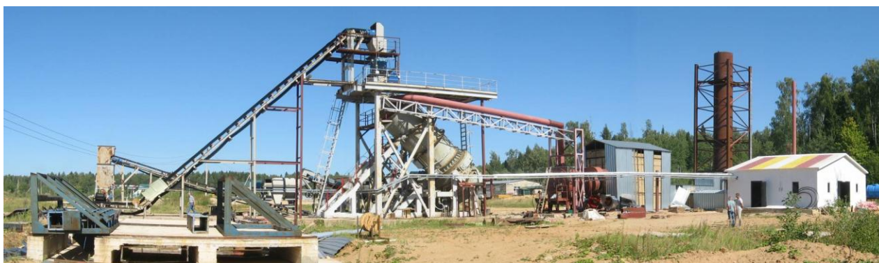
Газификатор промышленного масштаба, производительностью до 20 тыс. тонн в год (Московской обл., Рузский р-он)
